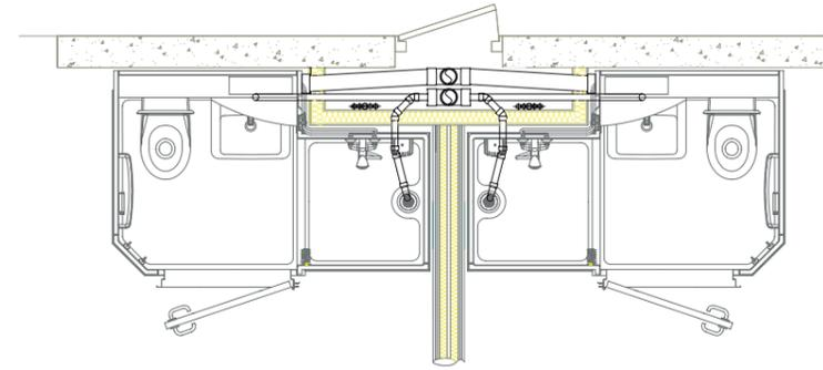
Principe de raccordement, ici représenté sur le modèle Tradiline, sur chute unique.
